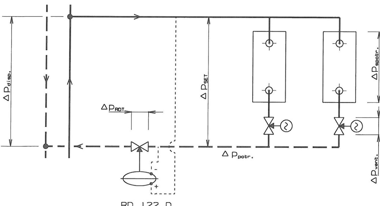
В случае, когда регулятор дифференциального давления должен обрабатывать высокий перепад давления ( $\Delta P_{RDT} > 250$  kPa) производитель рекомендует установку регуляторов и регулирующих клапанов на входной ветке контура. Этим обеспечиваются более благоприятные условия для работы регулятора, и повышение качества функции всей системы.
