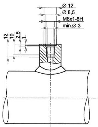
Патрубки для приварки для присоединения импульса давления входят в объем поставки вентиля.
