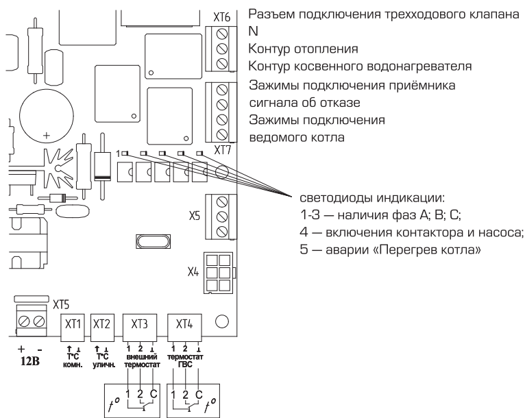
Рис. 5. Расположение разъемов на плате контроллера
