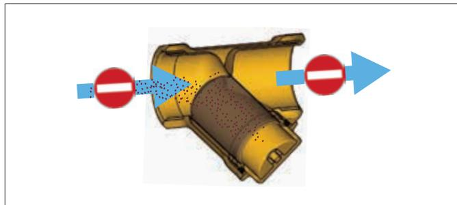
2) Открутить крышку и извлечь металлическую сетку.
