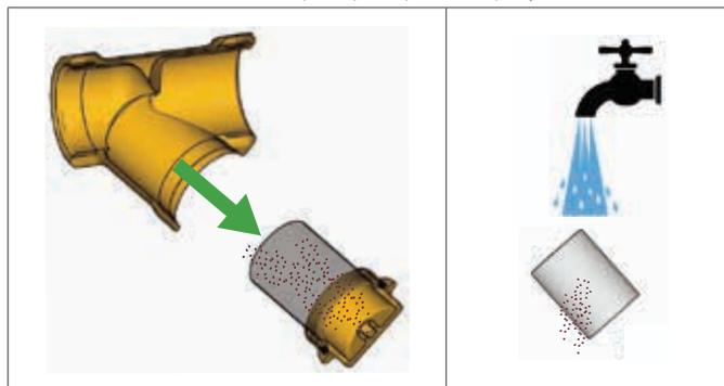
4) Установить металлическую сетку в крышку и закрутить в корпус фильтра.
