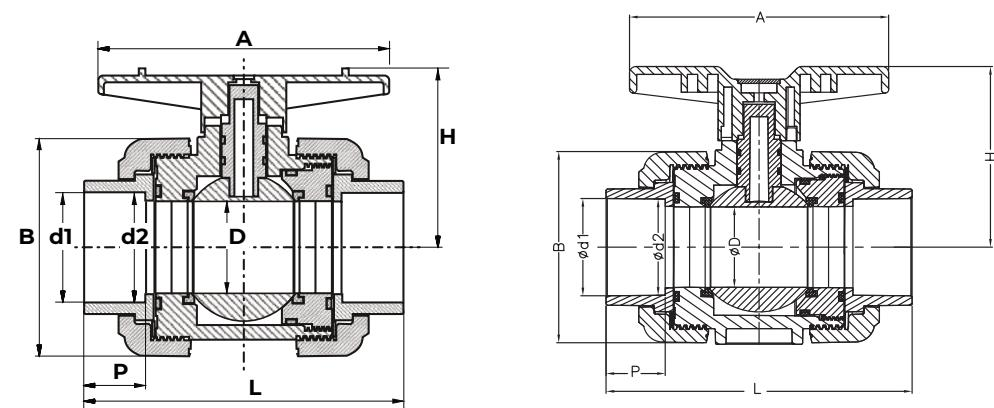
**СХЕМА КРАНА ШАРОВОГО ДО Ø63**
