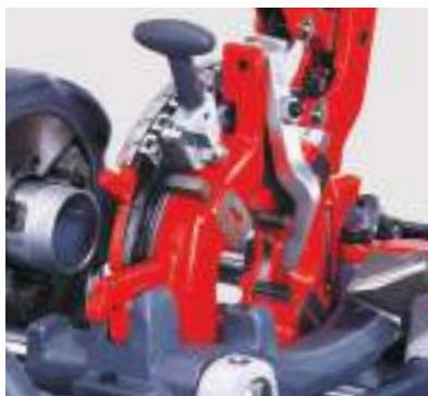
Ручная резьбонарезная головка со встроенной подачей масла
