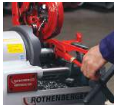
Обработка края резьбы (арт. 56500)
